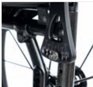
// QSC030012 Rücken, winkeleinstellbar, nicht abklappbar (75° - 105°)
